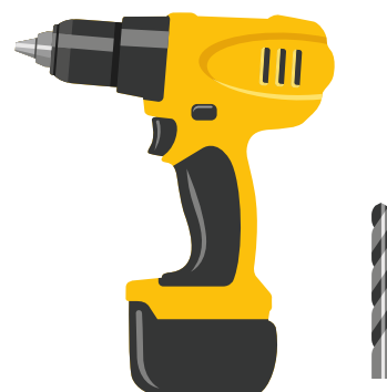
Obr. 3 Akumulátorová vrtačka a vrtáky, do kovu, do dřeva, do betonu
